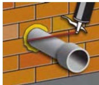
Schiuma poliuretanica monocomponente. Ideale per raggiungere le cavità e gli angoli più difficili, perché si estrude anche in verticale. Per effetto dell'umidità atmosferica la schiuma indurisce rapidamente formando una struttura a cellule chiuse, con ottime proprietà meccaniche e di isolamento termico e acustico, altamente impermeabile e adesiva. Non contiene (H) CFC, PCB o formaldeide. **Maxi formato: bombole 825 ml.**
