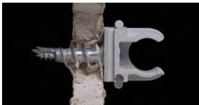
**RAPID ACCIAIO** è un nuovo tassello in acciaio autoforante indicato per supporti in calcestruzzo cellulare (GASBETON) e pareti in cartongesso. Simile a RAPID NYLON, permette applicazioni semplici e veloci poiché non necessita di foratura nel supporto. Indispensabile nelle applicazioni in cui si richiedono fissaggi conformi alle normative antincendio.
