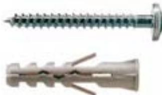
Tassello CONDOR, nella versione con bordo, completo di vite TL (testa larga) per un utilizzo senza rondella. Particolarmente indicato per il fissaggio di canaline elettriche.
